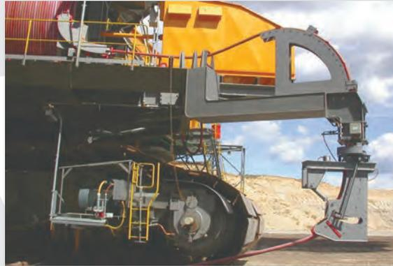
Neben der aufzuwickelnden Leitung ist die Umlenkvorrichtung das am meisten eingesetzte Zubehörteil: Sie lenkt die Leitung in vorher bestimmte Bahnen, um sie möglichst leitungsschonend auf den Trommelkörper auf- bzw. abzuwickeln.
