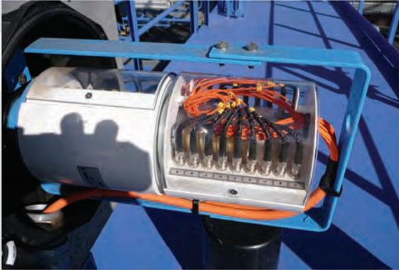
Die Lichtwellenleiter sind in speziellen Leitungen integriert, die die Tagebaugeräte mit Energie versorgen. *STEMMANN-TECHNIK* fertigt LWL-Drehübertrager, mit deren Hilfe die Daten von der sich drehenden Leitungstrommel unterbrechungsfrei in das Tagbaugerät übertragen werden.
