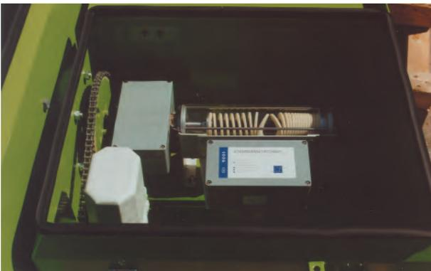
LWL-Drehübertrager für Leitungstrommeln bis zu 200 Umdrehungen
