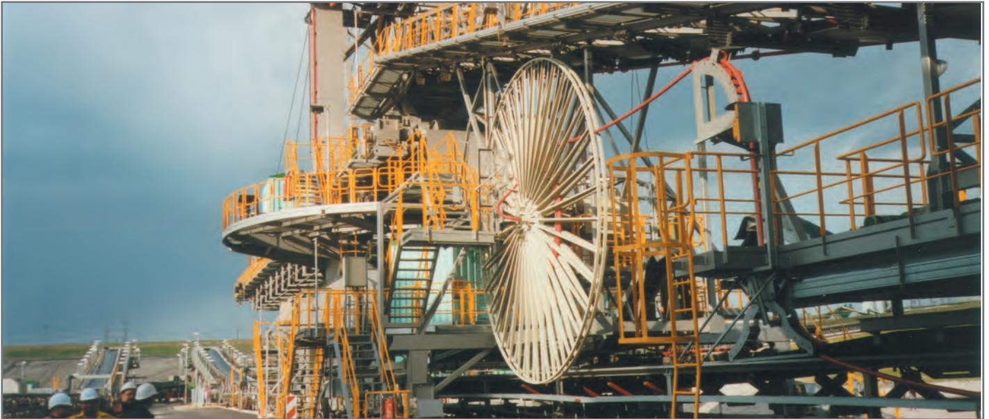
Das am meisten eingesetzte Zubehörteil - neben der aufzuwickelnden Leitung - ist die Umlenkvorrichtung. Sie wird bei einer spiralförmigen Leitungstrommel idealerweise unterhalb der Trommel platziert (siehe Skizze).
