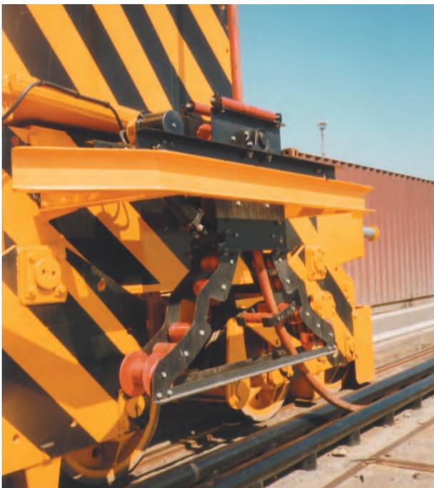
Mit Hilfe der Zugüberwachung wird ein zu starker bzw. ein zu geringer Leitungszug korrigiert.
